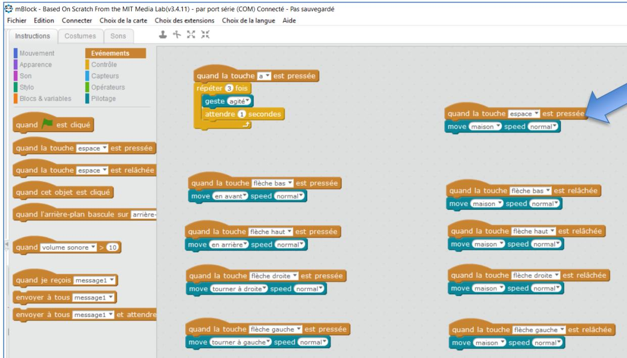
Exemple de programme qui gère les déplacements du robot avec les touches flèche droite, flèche gauche, flèche vers le haut et flèche vers le bas
